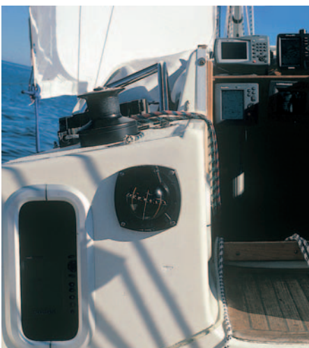
Bakom det öppningsbara fönstret sitter plottern placerad på ett gångjärn i skydd för sol och stöld.
